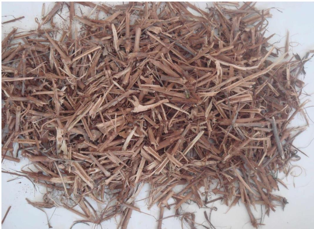
Рис. 2. Обрезки лозы после прохода измельчителя ИВ-1,5.
