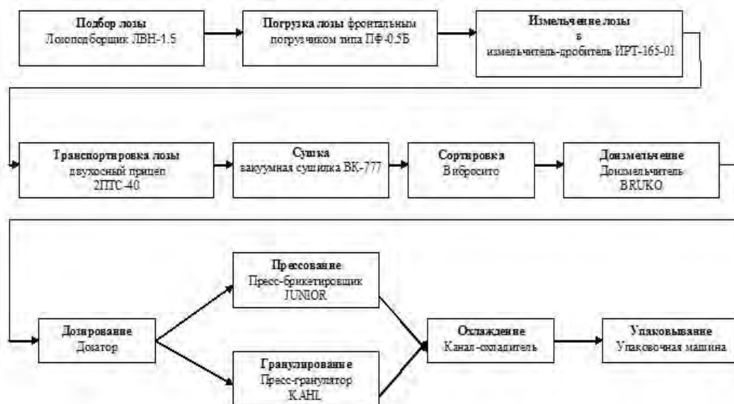
Рис. 3. Технологическая схема переработки обрезков лозы в топливные брикеты.
