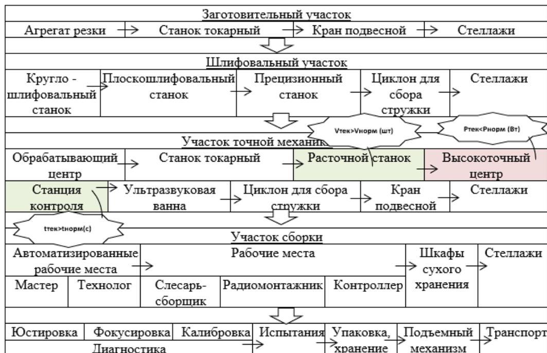
Рисунок 2. Слабое звено в производственной блок-схеме
