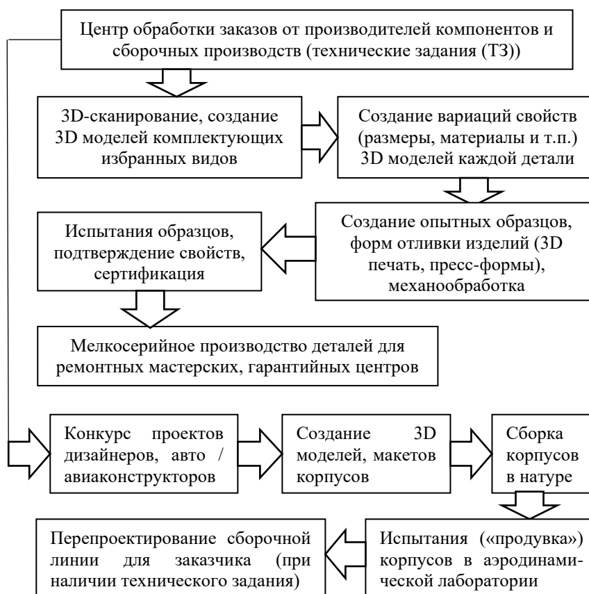
Рисунок 1. Концептуальная структура центра дизайна, прототипирования, испытаний образцов
