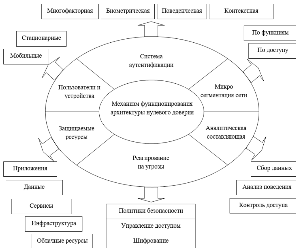
Рисунок 1. Мультипликативная модель функционирования архитектуры нулевого доверия на предприятии
